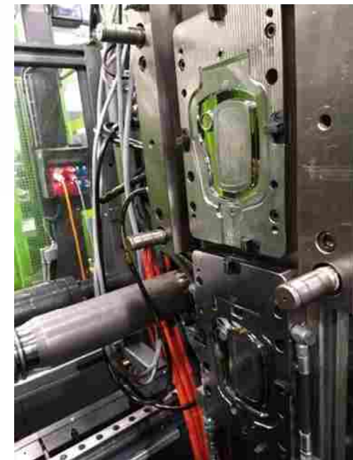
Lackieren im Werkzeug Paternosterwerkzeug am Kunststoff-Institut
